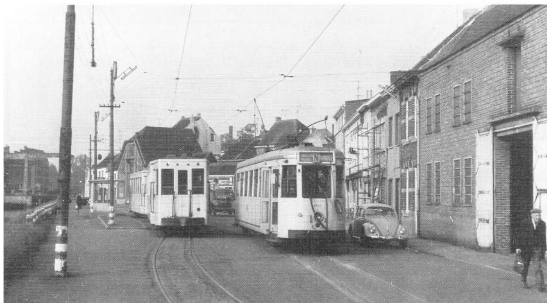
Lijn Ni : Ninove - Brussel Ninove - Denderkaai - terminus De losgekoppelde motorwagen rijdt langs de aanhangrijtuigen; na het heraan koppelen, zal de tram richting Brussel vertrekken
