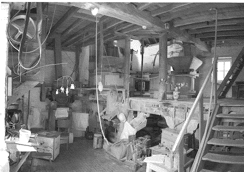
De molen met de maalstoel met twee werkende steenkoppels, in het midden de haverpletter en links tegen de zoldering de buil. Foto: F. B.
